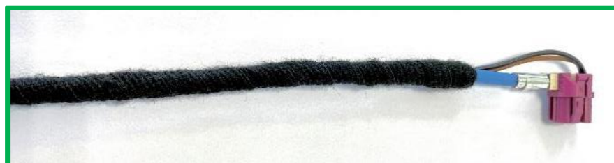
Abbildung 5-6 Bandagieren von MQS-Litzen
