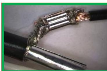
Abbildung 5-3 Splice (Bsp. Schirmverbindung)
