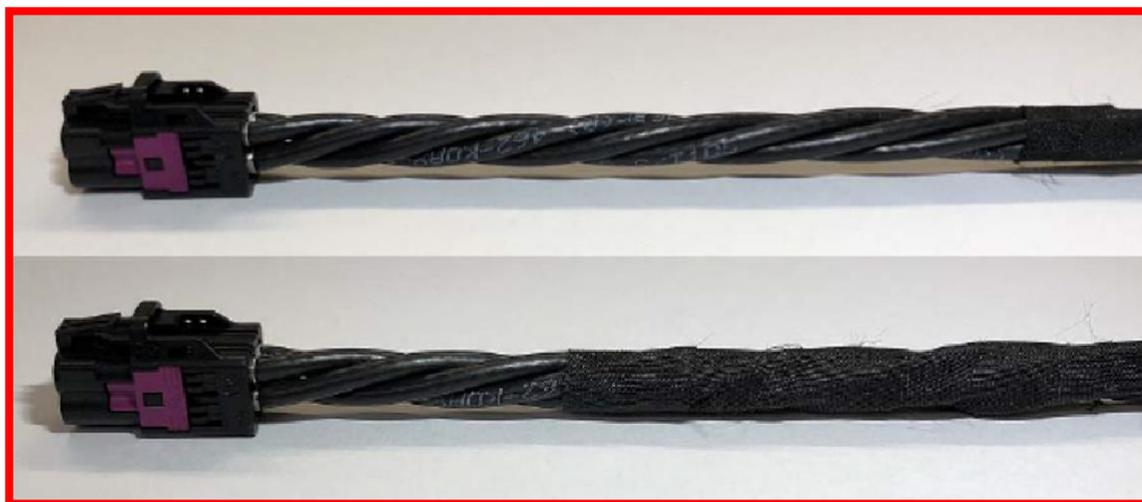
Abbildung 5-8 Falsch bandagierte Leitungen (Bsp. vierpoliges Stecksystem)
