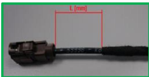
Abbildung 5-4 Bandagierte Einzelleitung (Bsp. einpolig)
