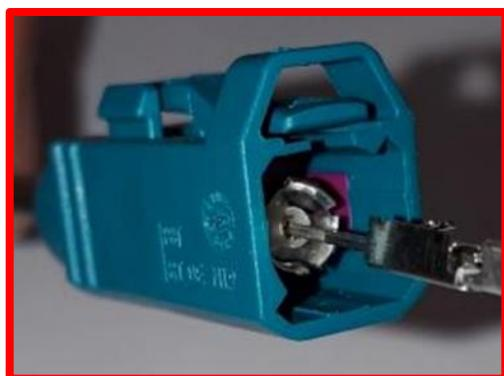
Abbildung 8-6 Bsp.: Falsche Prüfung Stecker
