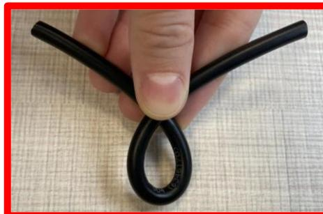
Abbildung 4-3 Falsche Handhabung (Bsp. Schlaufe)
