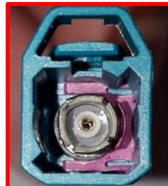
Abbildung 8-8 Bsp.: Beschädigung Stecker
